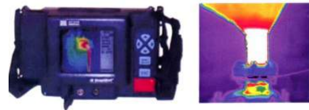
图5、红外成像仪及拍摄的温度分布图
